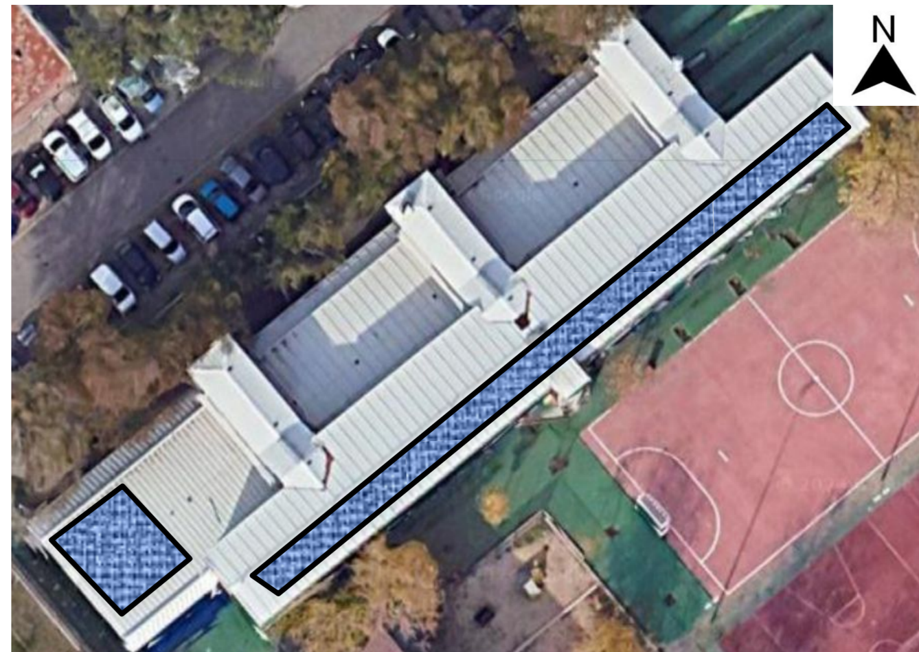
Edificio 2: 56 paneles 24,36 kWp
