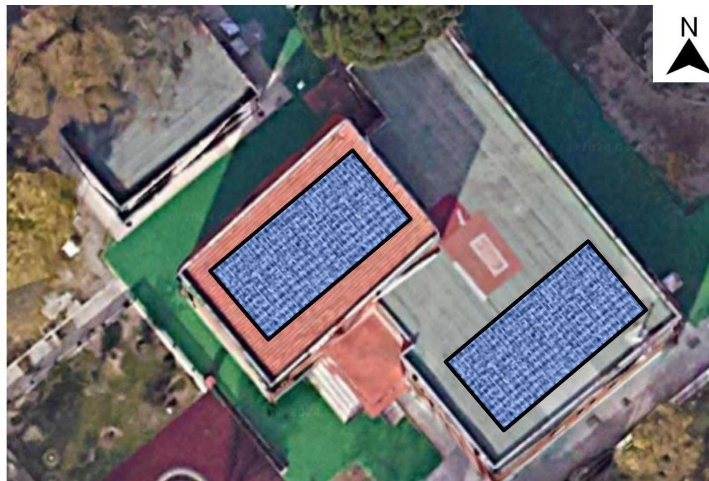
Edificio 4: 44 paneles 19,14 kWp
