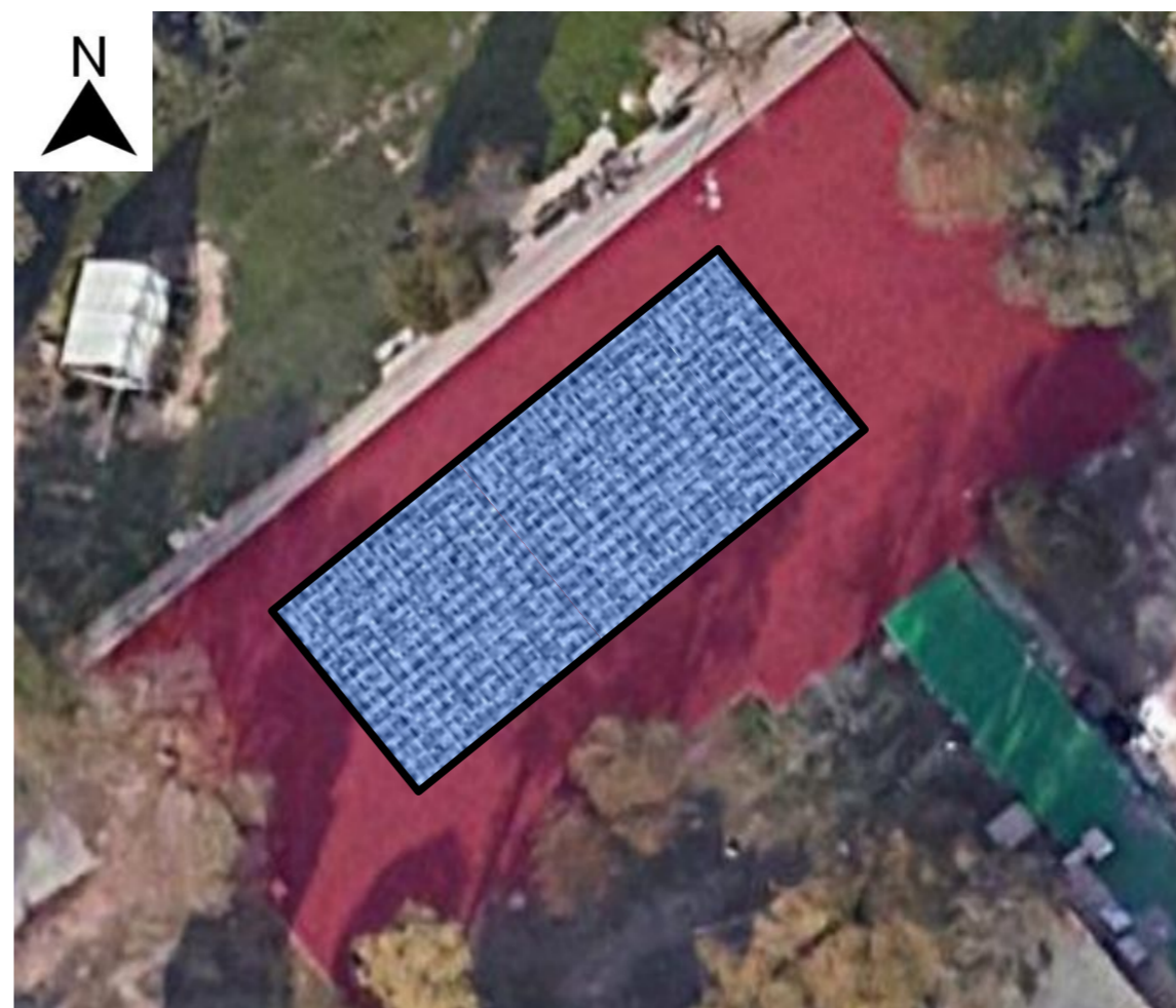
Edificio 3: 28 paneles 12,18 kWp
