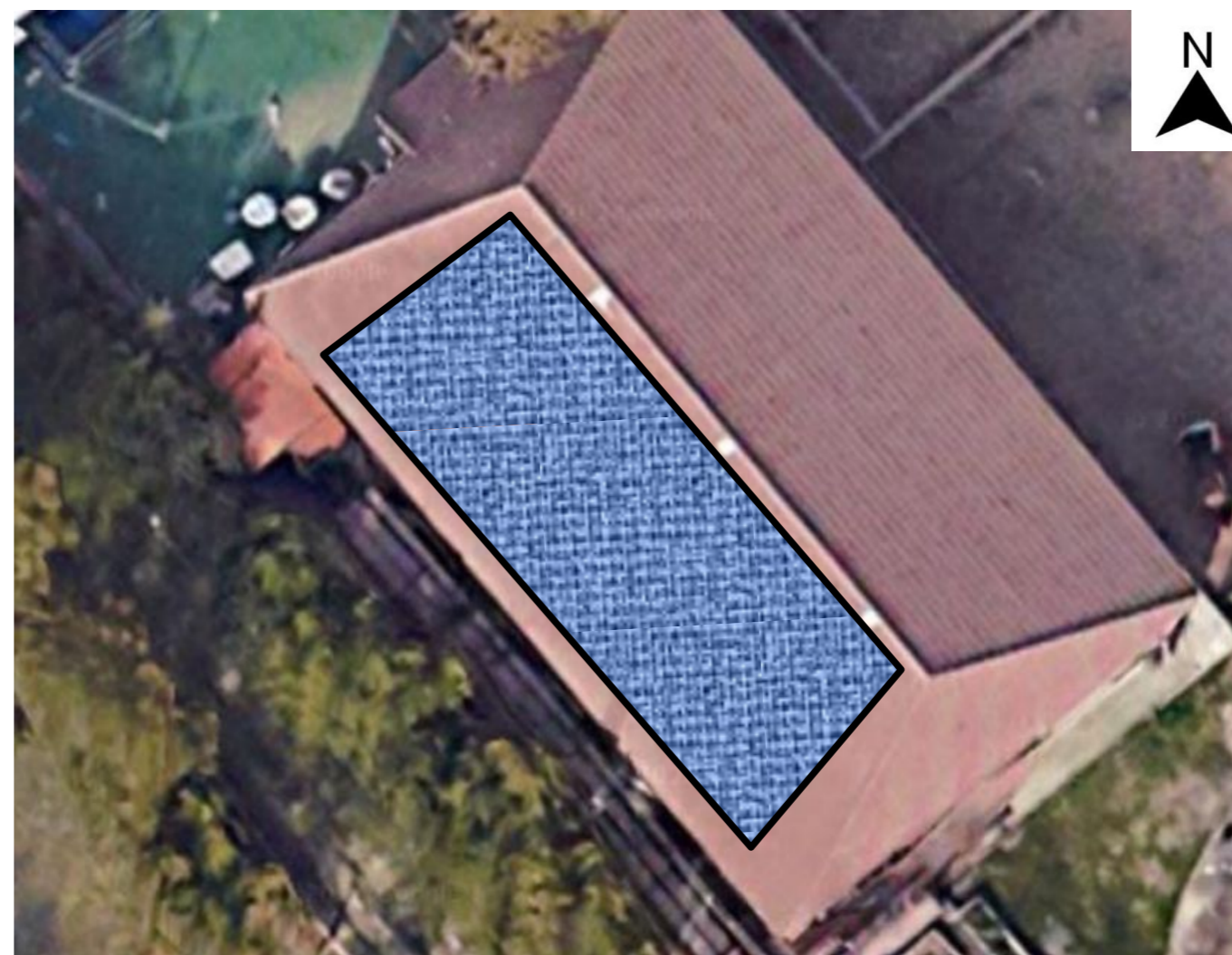
Edificio 1: 46 paneles 20 kWp
