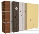
Con un aislamiento por el exterior reducimos las pérdidas de energía por fachadas y cubierta, y eliminamos los puentes térmicos.
